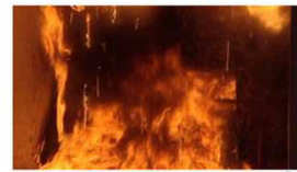
Das Wärmedämmverbundsystem aus Polystyrol hat im Versuch der Materialprüfanstalt Braunschweig lichterloh gebrannt
